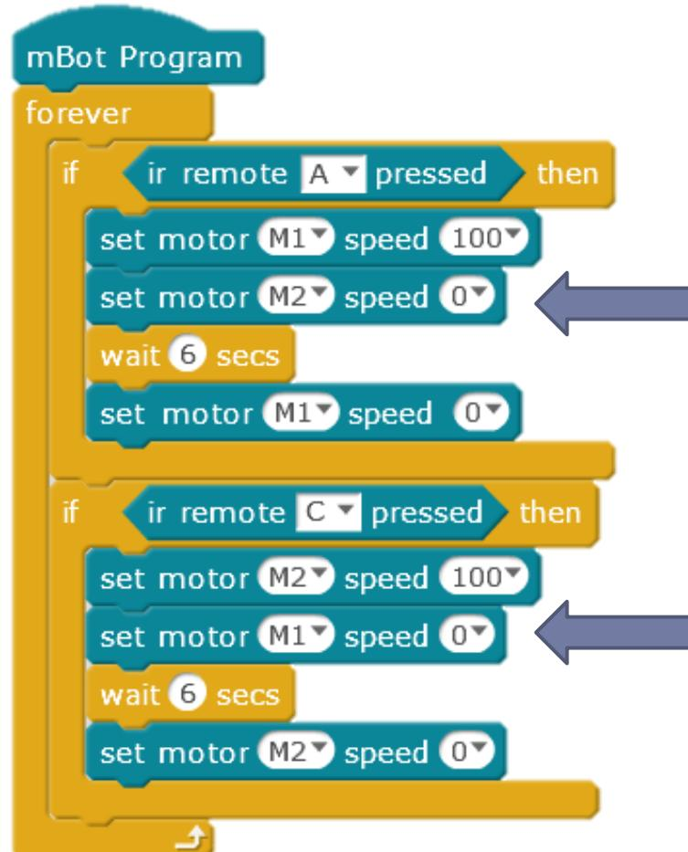
DESNI kotač miruje i robot se okreće DESNOG kotača
